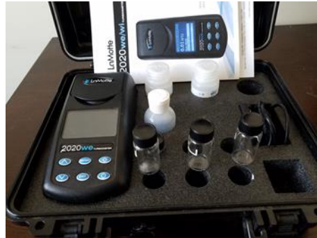
Photo 36 LaMotte we/wi Turbidimeter
