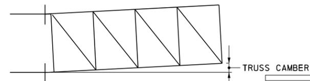
**TRUSS CAMBER DIAGRAM FOR CANTILEVER**
