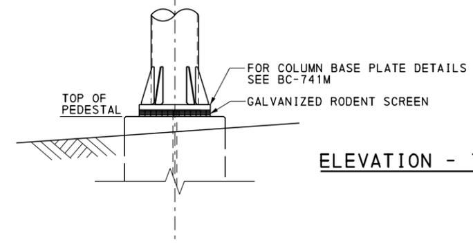
**ELEVATION - TYPICAL CANTILEVER SIGN SUPPORT**
