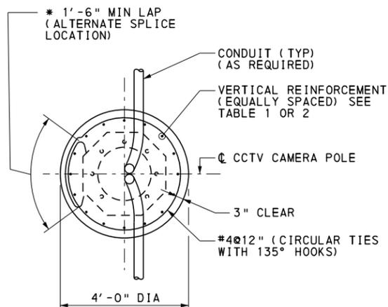
**DRILLED CAISSON PLAN**
