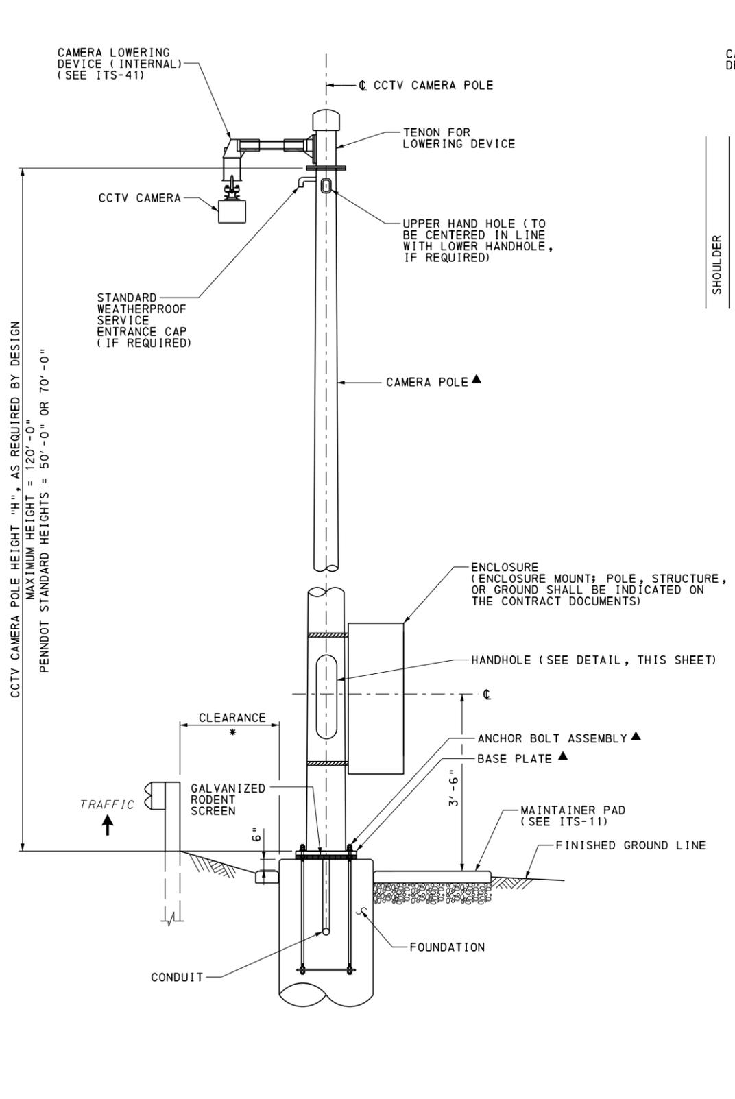
**CCTV CAMERA POLE ELEVATION**
