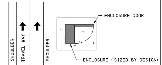
GROUND MOUNTED ITS ENCLOSURE ORIENTATION PLAN VIEW
