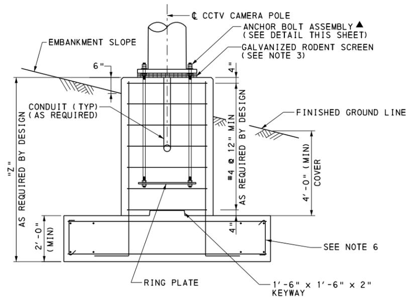
**SPREAD FOOTING ELEVATION ▲▲**
